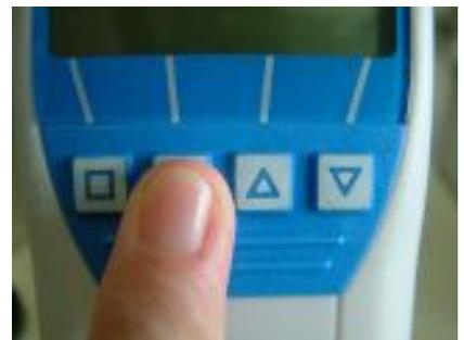
5. Nun kommt die Abfrage zur Selbstkalibrierung des Gerätes (Kalibrieren?). Diese muss mit der Taste **✓** bestätigt werden.
