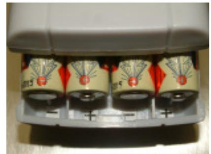
Erscheint das Batteriesymbol im Messfenster bzw. wird nach dem Einschalten oder im Statusfenster ein kritischer Ladezustand angezeigt (!), sind UNVERZÜGLICH die Batterien zu wechseln. Auch wenn das humimeter Gerät für längere Zeit nicht gebraucht wird, sind die Batterien aus dem Gerät zu entfernen. Für ggf. daraus resultierende Schäden gibt es keine Garantieansprüche.
