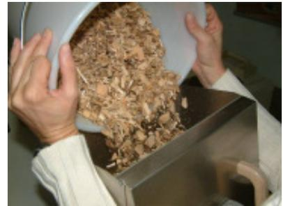
8. Nun muss solange Material entfernt werden, bis die nächst niedrigerer Gewichtsstufe erreicht wird. Fehlt nur wenig (z.B. 0,10kg) auf die nächst höhere Stufe, so soll auf diese aufgefüllt werden. Das aktuelle Gewicht des Hackgutes kann an der Waage abgelesen werden.
