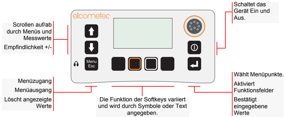
Abb. 6. Tastatur des Betondeckungsmessgerätes
