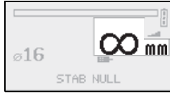
Abb. 13. Außerhalb der Reichweite für Bedeckungsmessungen
