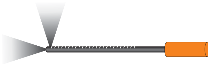
Abb. 19. Suchfelder der Bohrlochsonde
