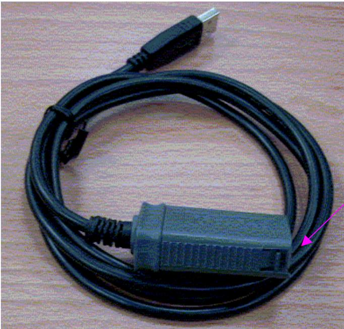
Zum Abnehmen des Kabels vom Multimeter immer den Schnappverschluss drücken.
