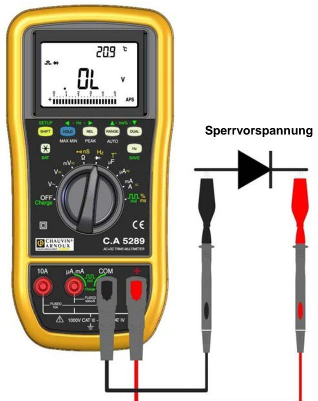
Abb. 53 – Sperrvorspannung Diodenmessung
