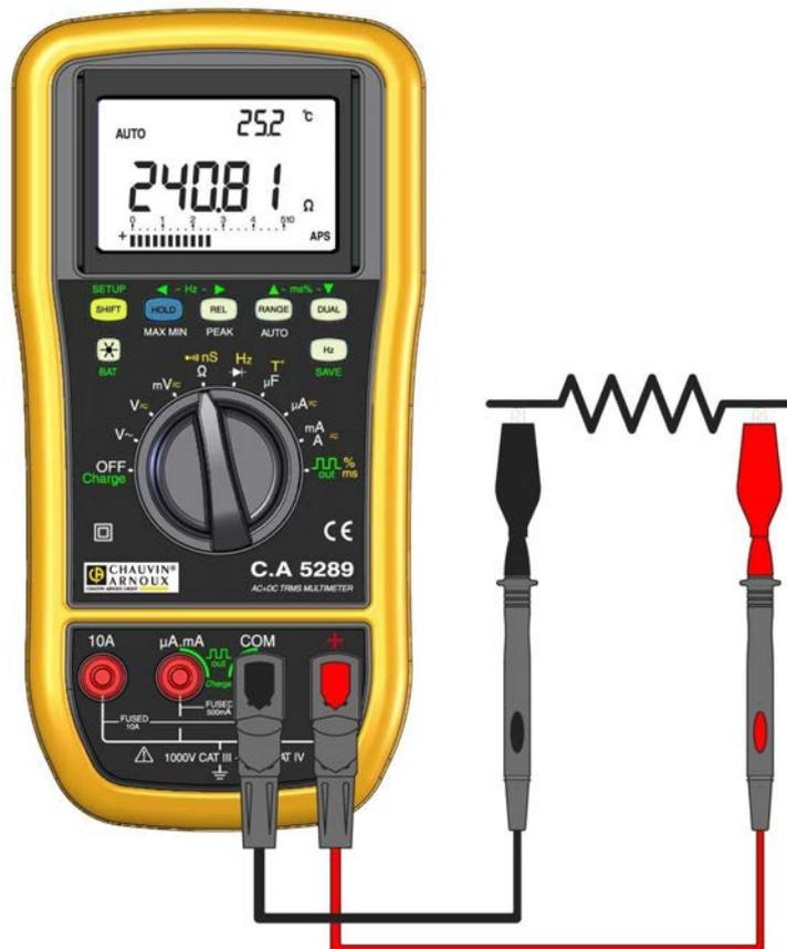
**Abb. 50 – Durchgangsprüfung**
