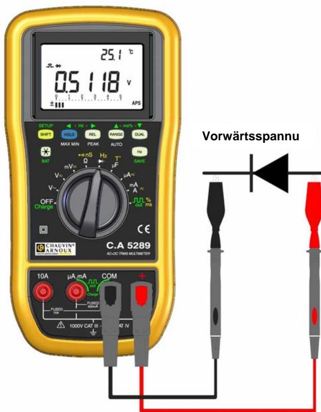
Abb. 52 – Vorwärtsspannung Diodenmessung
