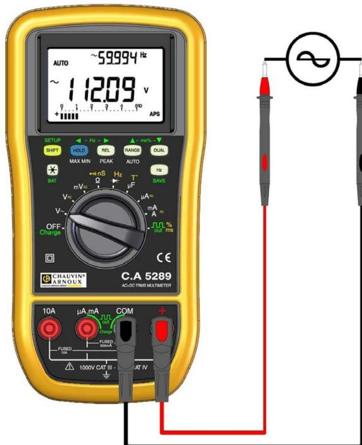
Abb. 42 – Versorgungsspannungsmessung
