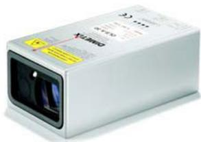
Die DLS-A Laser Sensoren messen Distanzen im Bereich von 0.2m bis 200m mit einer Genauigkeit von 3.0mm. Mit diesen Sensoren wird der Füllstand im Silo ermittelt. Je nach Genauigkeitsanforderung können mehrere Sensoren eingesetzt werden.
