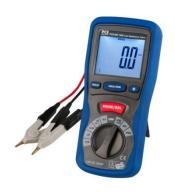
Mikroohmmesser misst kleinste Widerstände und somit kann die Verbindungsqualität von Klemmverbindungen, Schaltern, Relais, Generatoren, Transformatoren oder geschraubten Anschlüssen überprüft werden. Ebenso kann der PCE-MO 1000 den Widerstand von Schweißpunkten messen, die Leitungslängen überprüfen oder Durchgangsprüfungen an Ringsystemen (Ringbus) durchführen. Das Prinzip der Widerstandsmessung ist denkbar einfach, das Ohmmeter lässt über zwei Leitungen einen bekannten Strom durch das
