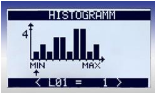
Darstellung der Häufigkeitsverteilung im Kraftmesser der PCE-FG K Serie
