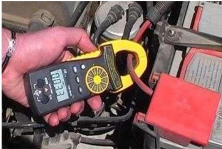
Zangenamperemeter CM-9940 beim Prüfen des Stromes beim Startvorgang.
