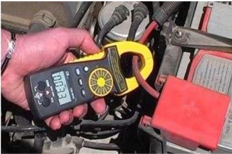
Zangenamperemeter CM-9930eff bei einer Strommessung einer Phase.
