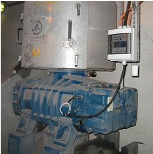
Hier sehen Sie den Vibrationsaufnehmer bei einer Überwachung an einer Rüttelmaschine
