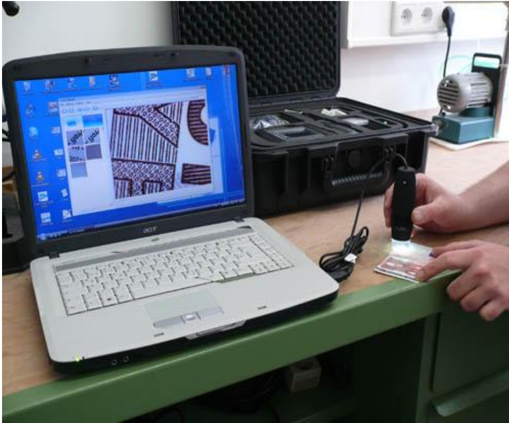
Untersuchung eines 10-Euro Scheins mit Hilfe vom USB - Mikroskop PCE-MM 200
