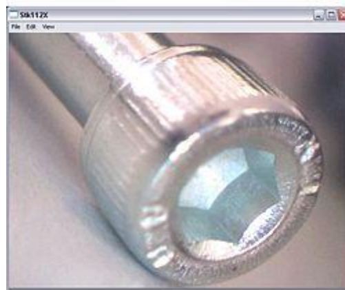
Hier sehen sie das USB - Mikroskop PCE-MM 200 bei der Materialprüfung
