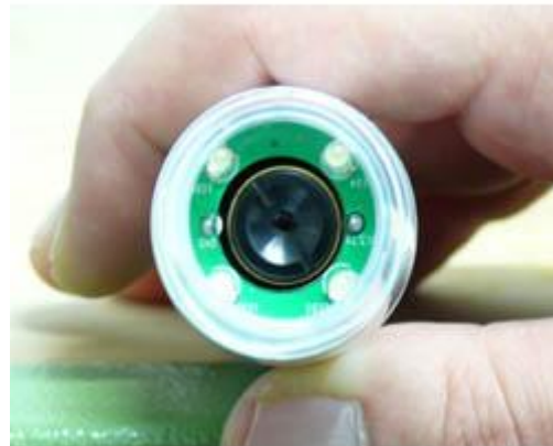
So sieht der Messkopf vom Mikroskop mit Beleuchtung aus
