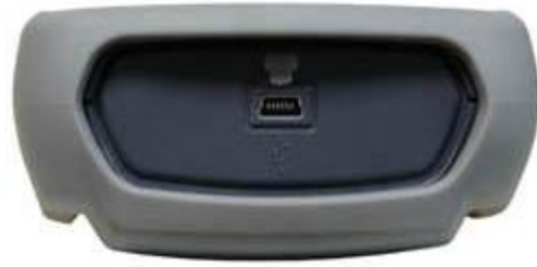
USB-Schnittstelle am Universalkalibrator PCE-C 456
