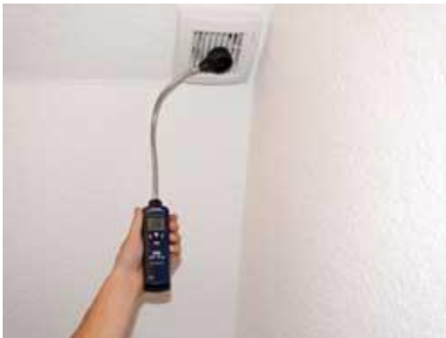
Das Thermo-Flügelrad-Anemometer PCE-TA 30 bei der Messung an einer Absaugung
