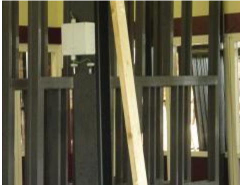
Feuchtigkeitssensor und ein Temperatursensor sind den Säulen montiert.
