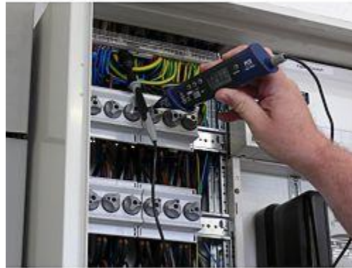
Hier sehen Sie das Stift-Multimeter PCE-PDM1 bei der Sicherungsüberprüfung.
