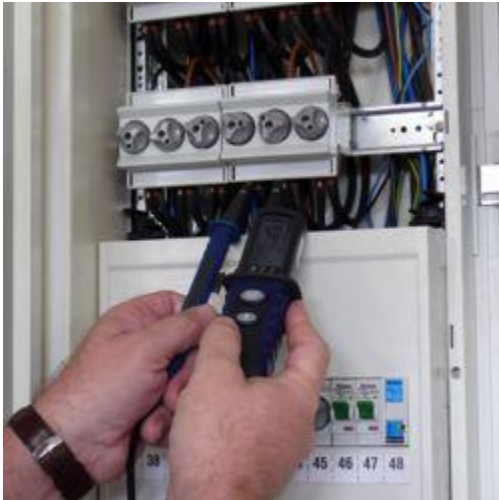
Spannungsprüfer PCE-322A bei einer Spannungsmessung in einer Elektroversorgung.
