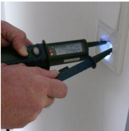
Spannungsprüfer PCE-TT1 bei einer Netzsteckdosenüberprüfung mit Messstellenbeleuchtung.
