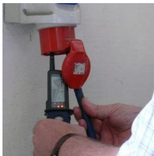
Spannungsprüfer PCE-TT1 bei einer Drehstromüberprüfung mit Drehfeldrichtungsanzeige.
