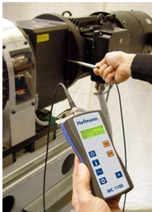
Das Schwingungsmesssystem MC 1100 Set bei der praktischen Anwendung an einer Maschine im Betrieb.
