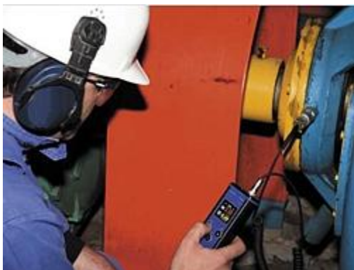
Der Schwingungsanalysator PCE-VT 250 ermöglicht Ihnen den Betriebszustand an Lager und Maschinen zu diagnostizieren
