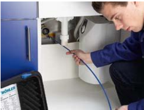
Das Videoskop lokalisiert Beschädigungen, z.B. an Abwasserrohren / Fallrohren in Gebäuden
