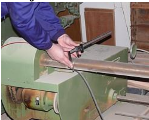
Schieblehre PCE-DCP 600N bei einer Kontrollmessung an einer Welle
