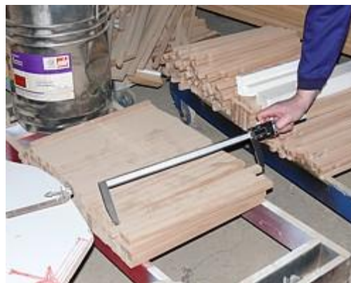
Schieblehre PCE-DCP 600N bei einer Zwischenkontrolle von Holzplatten
