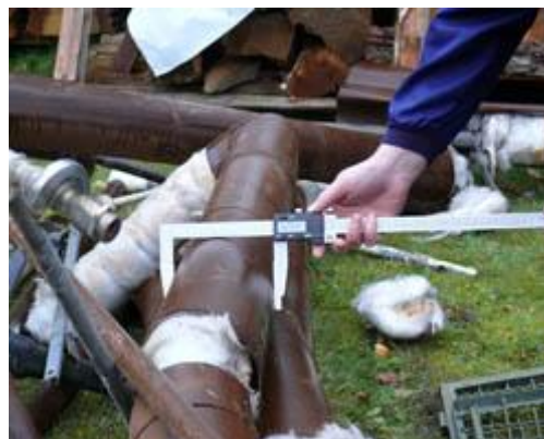
Hier sehen Sie die Schieblehre PCE-DCP 600N bei einer Messung an einer Rohr-Isolierung
