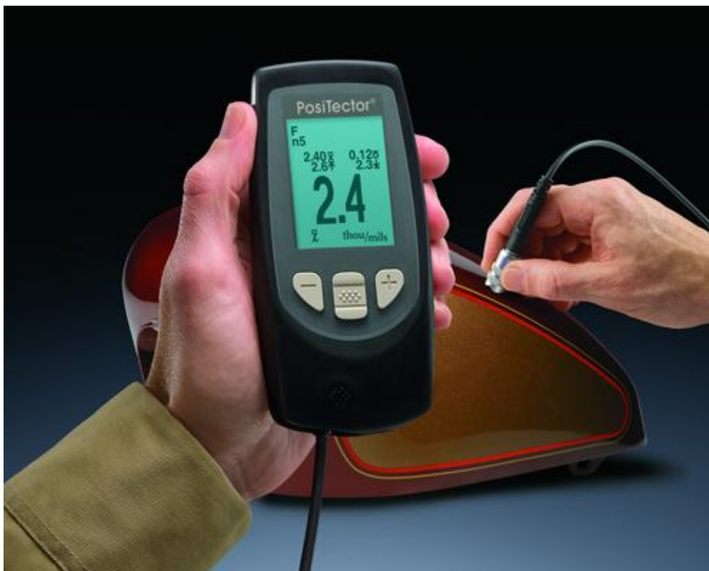
Hier sehen Sie das Schichtdickenmessgerät bei einer Schichtdickenkontrolle an einem Motorradtank.
