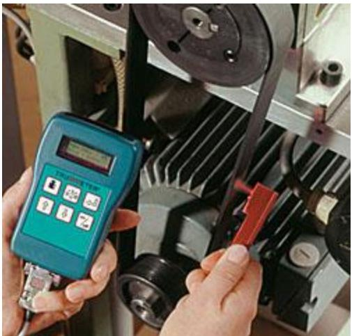
Der Abstand des Riemenspannungsmessgeräts zwischen Antriebsriemen und der Riemenspannungsonde sollte mindesten 3 ... 20 mm betragen.
