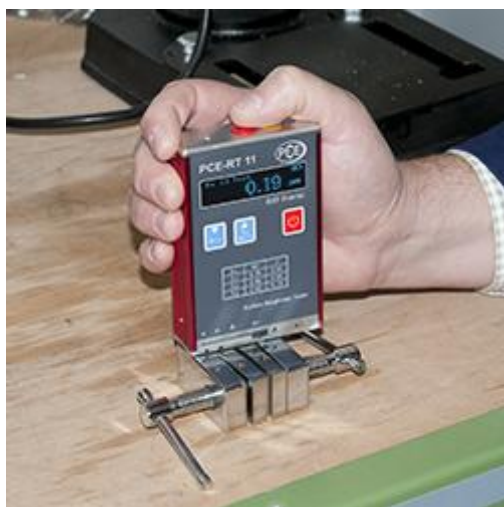
Das Rauigkeitsmessgerät bei einer Oberflächenprüfung an einer Klemmblocke.
