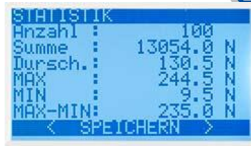
8 Speicherplätze mit individueller Beschriftung und jeweils 800 Messungen im Präzisions-Kraftmessgerät.
