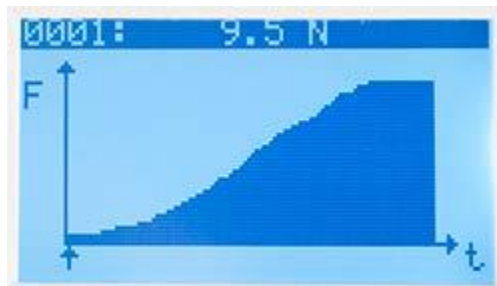
Präzisions-Kraftmessgerät: Auswertung bzw. des Speichers in Diagrammform wobei einzelne Messpunkte abgefragt werden können.
