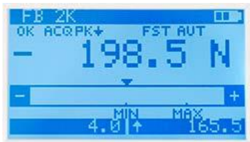
Präzisions-Kraftmessgerät: Informationen wie Batteriezustand, Messgeschwindigkeit, Kraft, Min und Max auf einen Blick.
