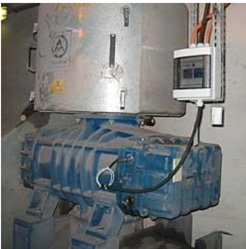
Hier sehen Sie den Piezo-Vibrationssensor bei einer Überwachung an einer Rüttelmaschine
