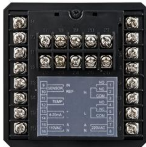
Hier sehen Sie die Anschlüsse des PCE-PHC 1
