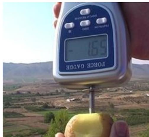
Penetrometer bei der Ermittlung der Festigkeit von Kartoffeln mit einer Spitze von Ø 8 mm
