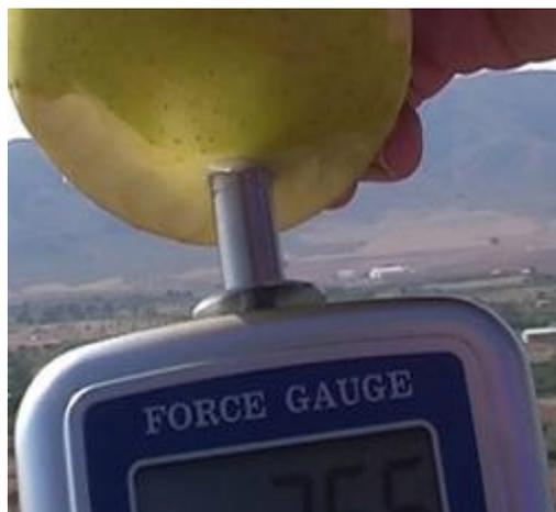
Penetrometer bei der Ermittlung der Festigkeit von Äpfeln mit einer Spitze von Ø 11 mm
