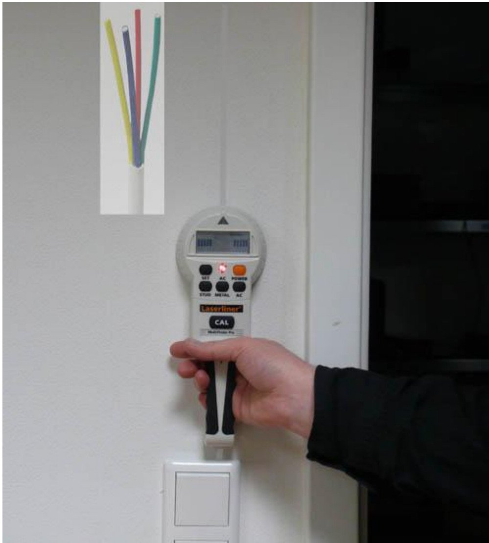
Metall-Scanner im Einsatz bei der Suche von verborgenen Leitungen in der Wand.
