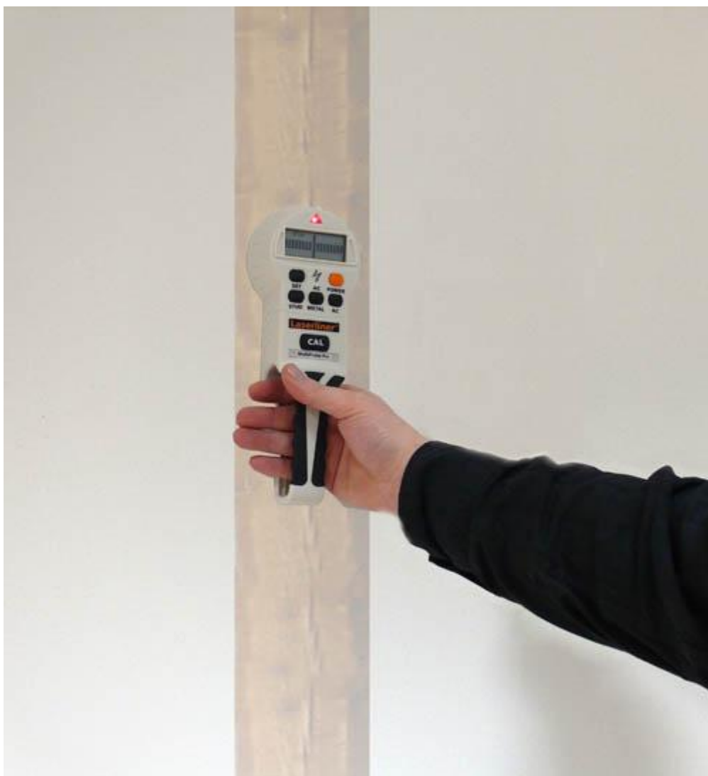
Ortungsgerät im Einsatz bei der Suche von verborgenen Holzbalken in der Wand.
