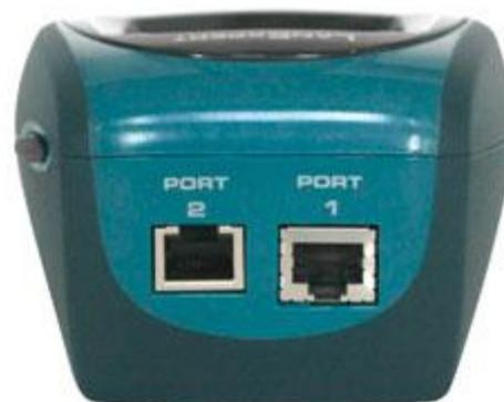
Am Netzwerk Testgerät LanExpert befinden oben die Netzwerkports und unten die entsprechenden Ports für USB, Netzwerk und Stromanschluss.
