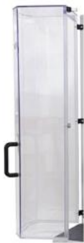
Motorisierter Zug-Druck-Prüfstand PCE-TF 3 / PCE-TF 5: geeignete Makrolon - Schutzhaube mit elektronischem Türkontakt
