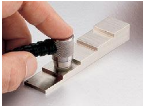
Eine einfache und genaue Re-Kalibrierung kann mittels dem Prüfbock erfolgen.
