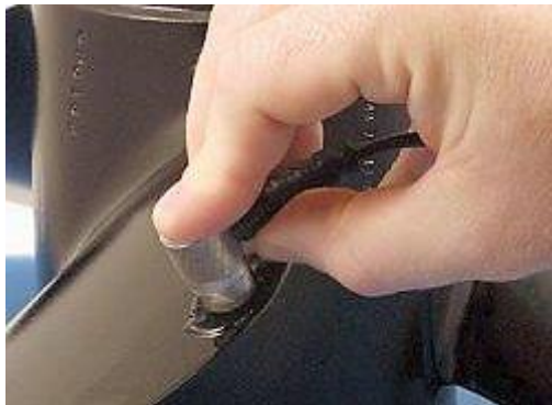
Das obige Bild zeigt den Materialdickenmesser im Einsatz an einer Schiffsschraube.
