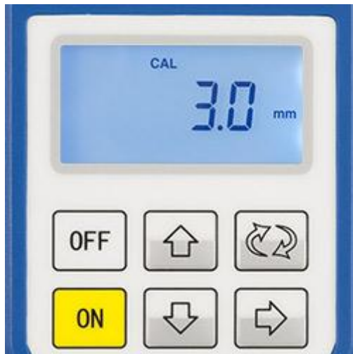
Kalibrierung vom Materialdickenmessgerät auf dem integrierten Standard.
