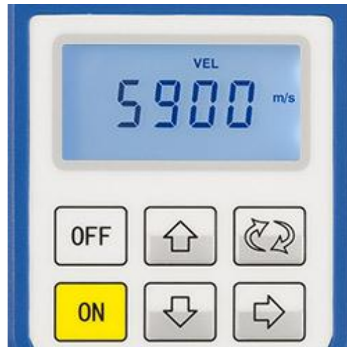
Einstellung der Schallgeschwindigkeit am Materialdickenmessgerät
