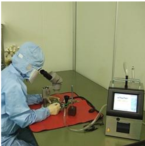
Hier sehen Sie den Luftpartikelzähler bei einer Untersuchung in einem Reinraum
