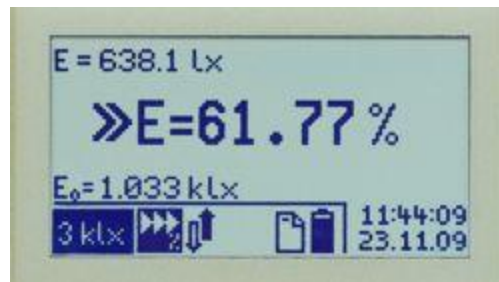
Prozentuale Vergleichsmessung des Lichtmessgerätes PCE-L 100
