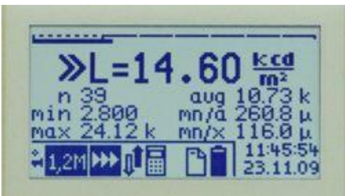
Display bei Messung der Leuchtdichte inkl. Anzeige der Statistik
