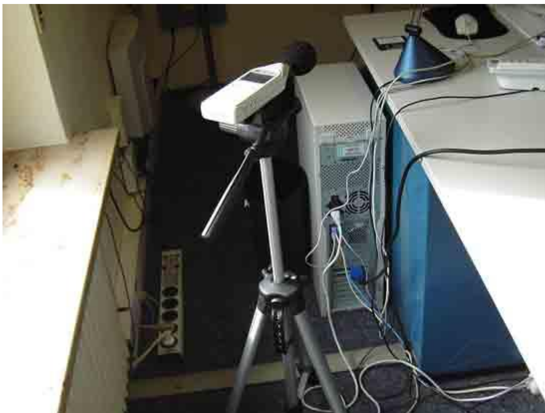
Das vielfach verstellbare Stativ für das Lärmmessgerät PCE-353 für Langzeitmessungen vor Ort.
