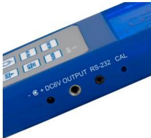
Hier sehen Sie die verschiedenen Ein- und Ausgänge von unserem LEQ - Schallmessgerät
