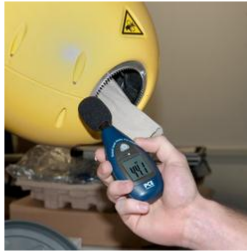
Hier der Lautstärkemesser bei der Messung in einer Produktionshalle
