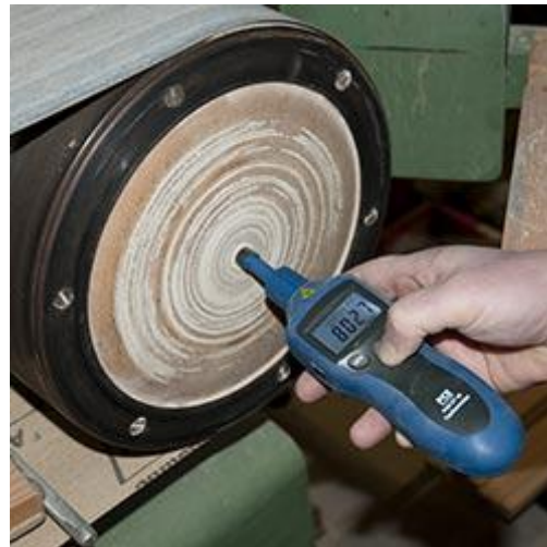
Der Laser Umdrehungsmesser bei einer Kontaktmessung.
