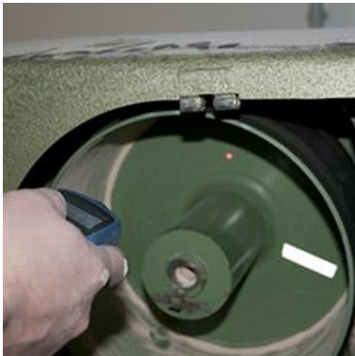
Der Laser Umdrehungsmesser bei einer kontaktlosen Messung.
