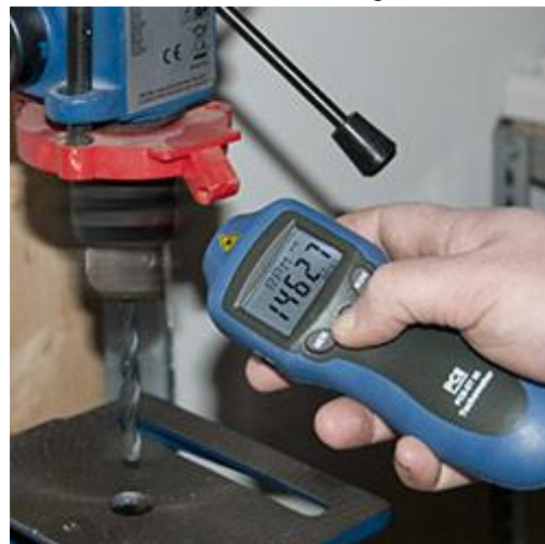
Der Laser Umdrehungsmesser bei einer kontaktlosen Messung an einer Bohrmaschine.
