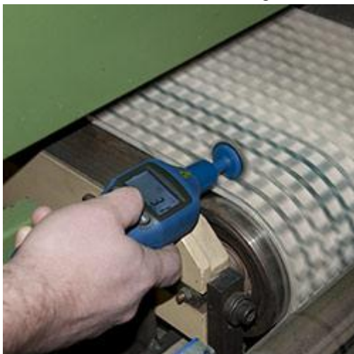
Der Laser Umdrehungsmesser bei einer Kontaktmessung an einem Förderband.
