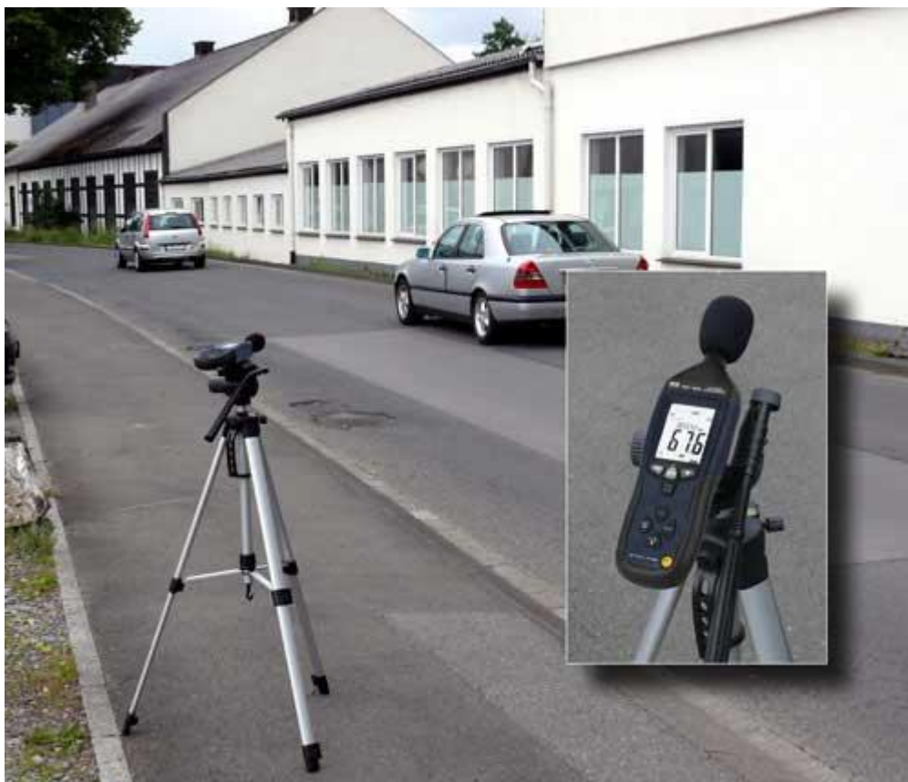
Lärmmessgerät PCE-322 A im Einsatz bei der Messung von Verkehrslärm
