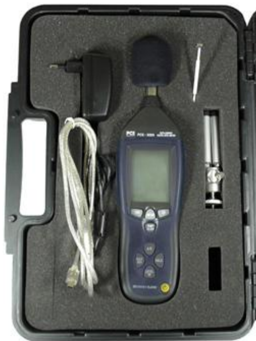
Schallmessgerät PCE-322 A mit Lieferumfang im sicheren Transportkoffer.
