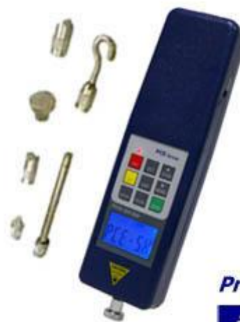
Kraftmessgerät PCE-SH 500 mit im Lieferumfang enthaltenem Zubehör
