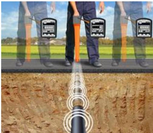
Das Kabelortungsgerät Easyloc bei der Ortung einer im Erdreich verlegten Leitung
