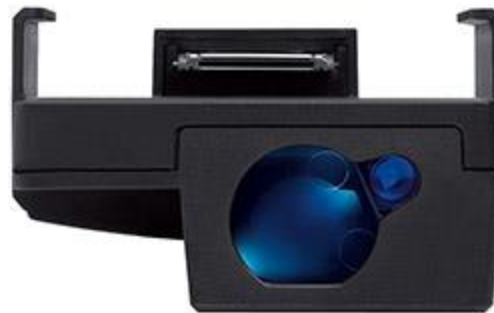
Ansicht vom iPhone Laser-Entfernungsmesser von oben. Dort werden die Messungen durchgeführt.
