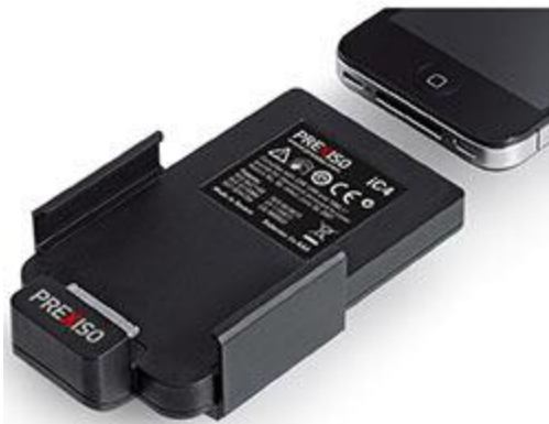
Der iPhone Laser-Entfernungsmesser wird lediglich an das Smartphone angedockt.
