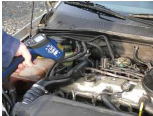
Einsatz vom Infrarotmessgerät an einem Motorblock
