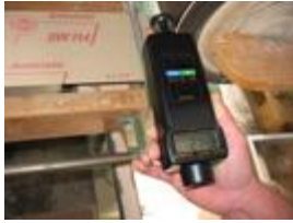
Kontaktierende Drehzahlmessung an einer Verpackungslinie
