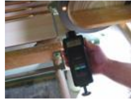
Optische Drehzahlmessung an einer Kreissäge
