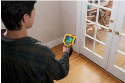
Die Gebäudethermografie Kamera hilft dabei, Stellen aufzuspüren, an denen Energie entweicht.
