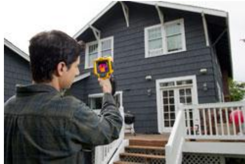
Eine Gebäudethermografie Kamera ist wichtig um eine optimale Wärmedämmung zu gewährleisten.
