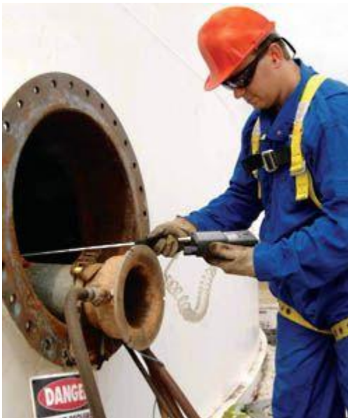
Hier sehen Sie das MX6 iBRID bei der Messung in einem Behälter
