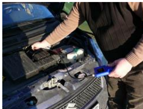
Inspektion am gasbetriebenen Motor (LPG)
