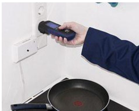
Der FI-Tester / RCD- Tester PCE-RCD 1 bei der Anwendung im Haushalt. Das übersichtliche Display erleichtert die Bedienung.
