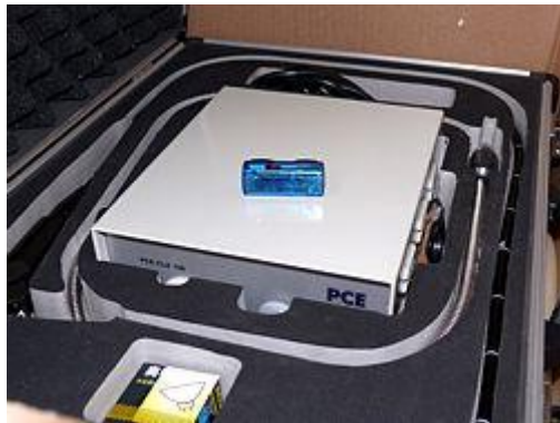
Der Mini-Datenlogger PCE-MSR145 (Standard) in der Versand- u. Transportüberwachung
