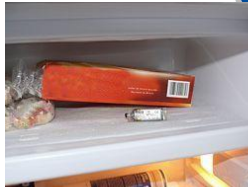
Der Mini-Datenlogger PCE-MSR145 (Wasserdicht) in der Kühlkettenüberwachung
