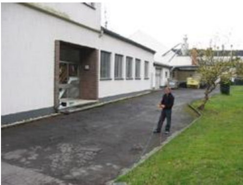
Zur Prüfung der Erdung sind die Prüflleitungen in den Abständen (wie in der Bedienungsanleitung angegeben) zu verlegen.
