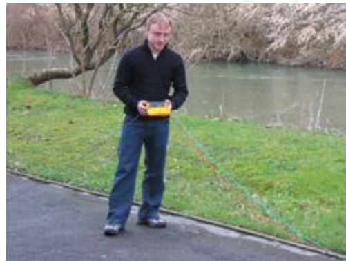
Der Prüfende hat die Leitungen korrekt verlegt und schaltet nun den Erdungsmesser ein. Das Messgerät kann auch auf dem Boden stehen.
