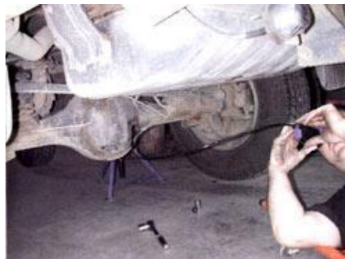
Endoskop bei der Getriebeuntersuchung
