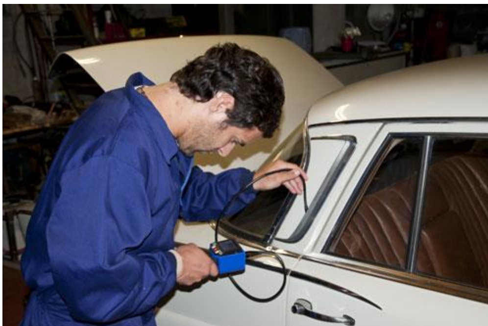
Das Endoskop PCE-DE 25 bei einer Inspektion des Fensterholmes eines Oldtimers
